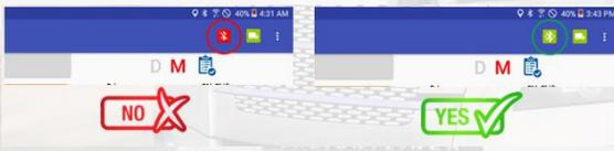
Estatus de la conexión del ECM: En todo momento el libro electrónico debe ser capaz de leer los datos del motor del vehículo. Asegúrese que el indicador de conexión permanece siempre en verde. Si el indicador de cambia a rojo, por favor ejecute la opción “Buscar Dispositivo” en el menu y conéctese al a computadora del camión.
